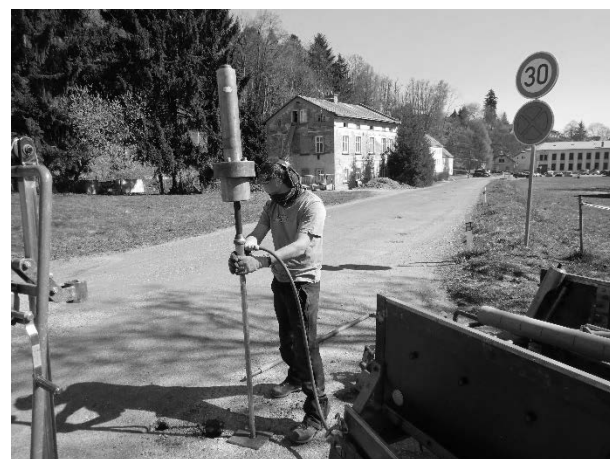
Obr. 5,6: Pohled k jihovýchodu na provádění zkoušky DPH4; pohled k východu na osazení vsakovací zkoušky VSAK1.
