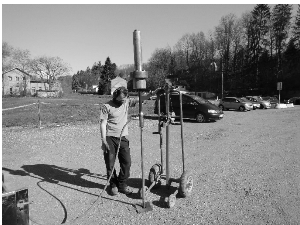
Obr. 1,2: Pohled k východu provádění sondy dynamické penetrace DPH1; dtto hloubení jádrové sondy S1.
