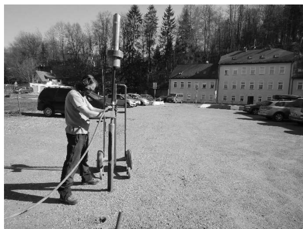
Obr. 1,2: Pohled k východu provádění sondy dynamické penetrace DPH1; dtto hloubení jádrové sondy S1.
