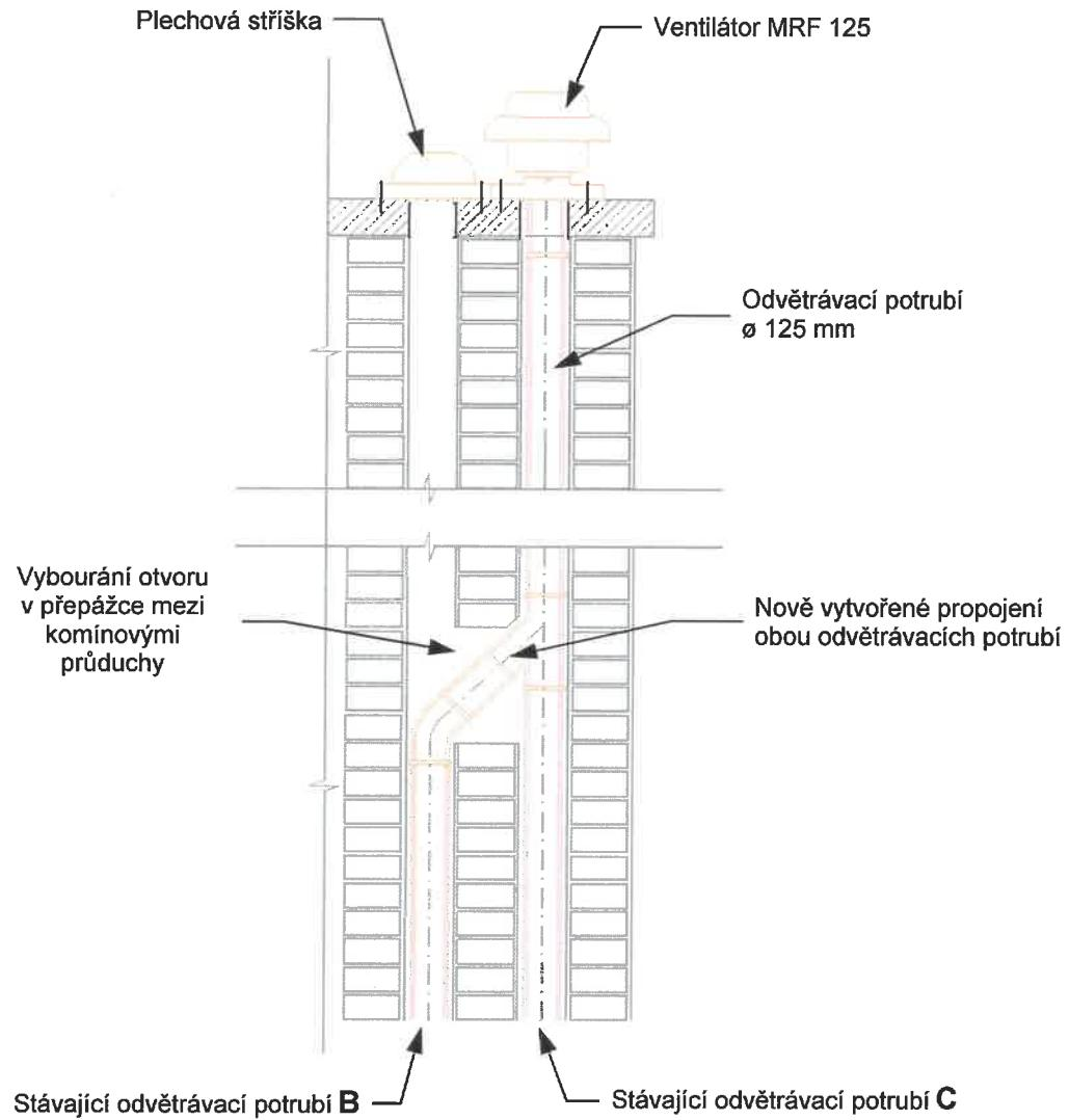
Množství a typ potrubních redukcí a přechodových kusů se zvolí až po zjištění skutečného typu a průměru stávajících odvětrávacích potrubí, tzn. po otevření komínového tělesa.
